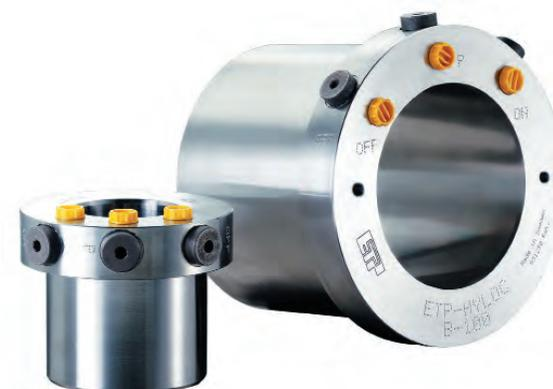
La bussola ETP-HYLOC è un'unità di collegamento idromeccanica albero-mozzo che, grazie alla robusta esecuzione, è particolarmente indicata per applicazioni impegnative quali laminatoi, industria di processo, ecc. La bussola ETP-HYLOC è rapida da montare, presenta buone caratteristiche di concentricità ed è in grado di sopportare carichi radiali e coppie elevate. Il montaggio e lo smontaggio della bussola vengono effettuati con l'ausilio di una pompa idraulica.
