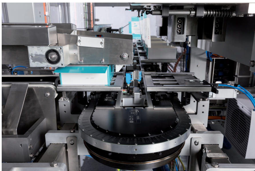
GFX è un sistema di trasporto flessibile a carrelli indipendenti che sfrutta un motore lineare e un track con profilo a "V".
