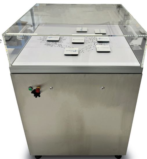
Il motore planare è un sistema di trasporto all'avanguardia che utilizza la tecnologia di levitazione magnetica, offrendo fino a sei gradi di libertà di movimento.
