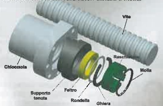
La nuova tenuta con raschiatori caricati a molla.
